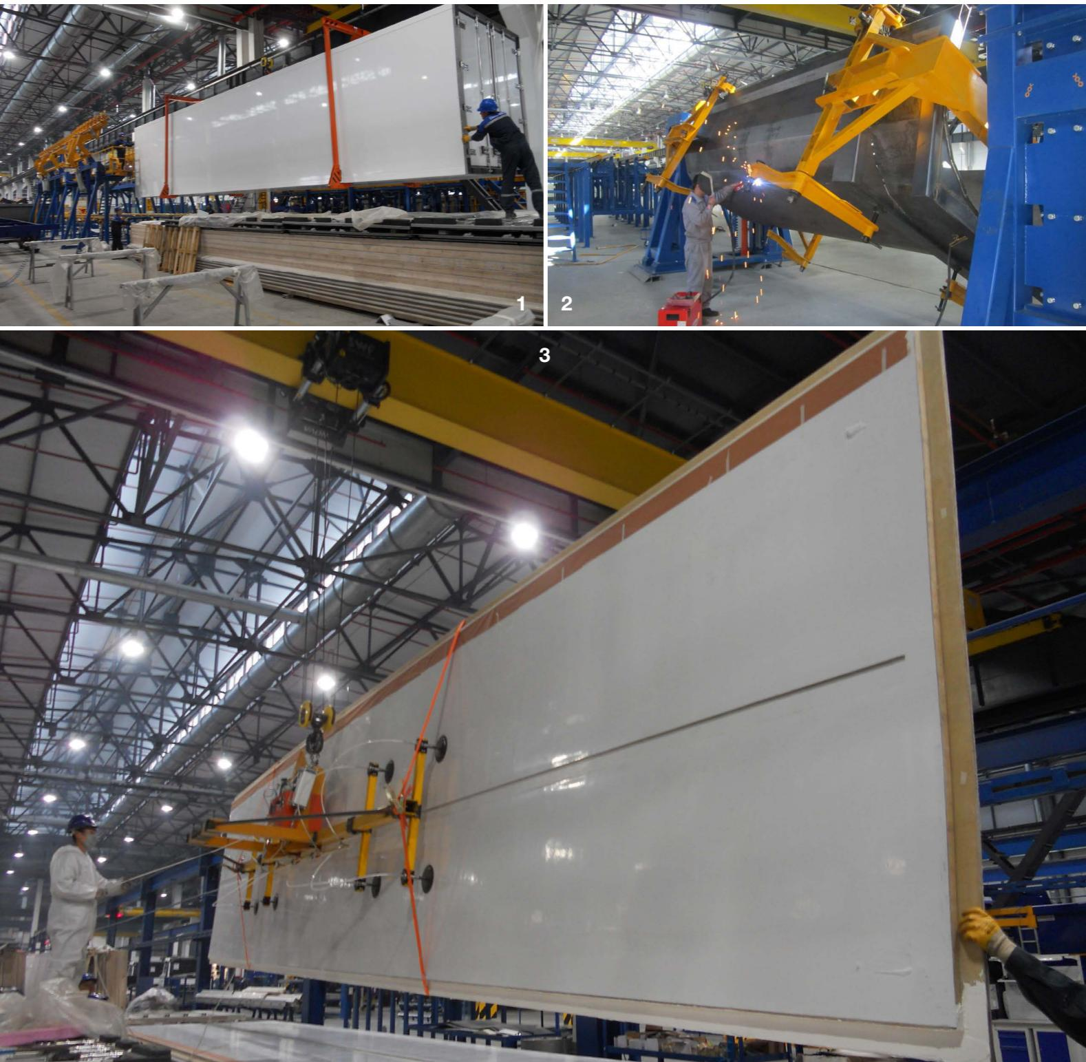
Применение специальных грузозахватных приспособлений значительно повышает эффективность транспортных операций: увеличивает производительность, обеспечивает безопасность, исключает деформацию изделий при проведении работ.
