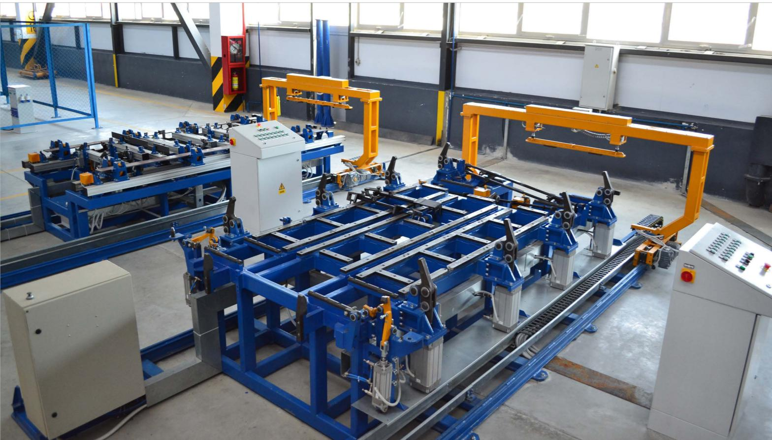
Стенд предназначен для сборки консольной части рамы полуприцепов, а также сборки консольной части рамы с настилом пола.
