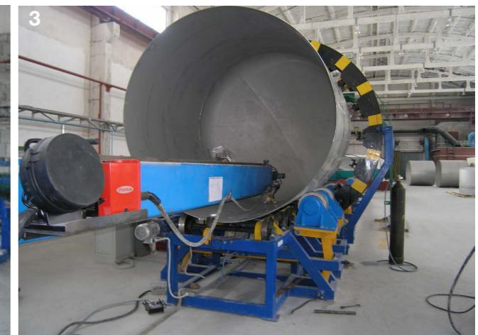
1. Линия сборки и автоматической сварки котлов.
