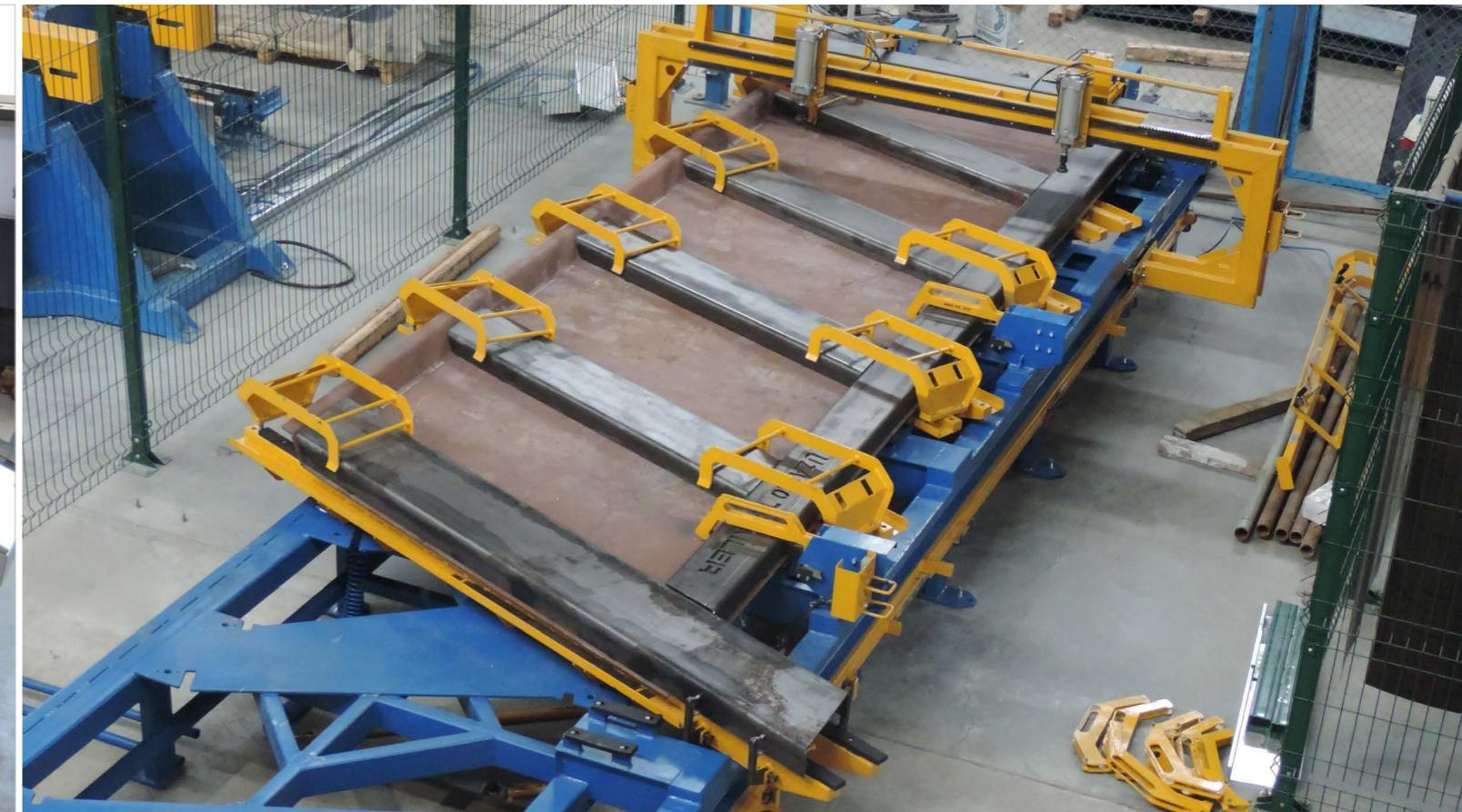
Стенд предназначен для сборки боковин кузова самосвала в нормальном положении.
