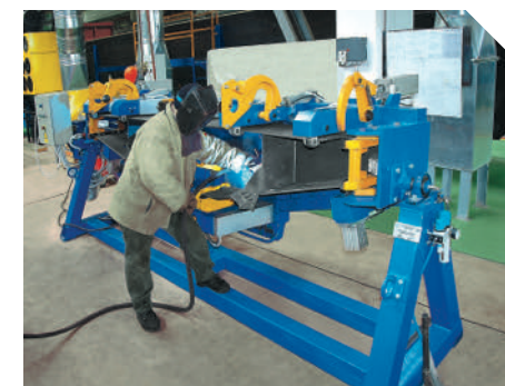
Стенд сборки лобовых балок
