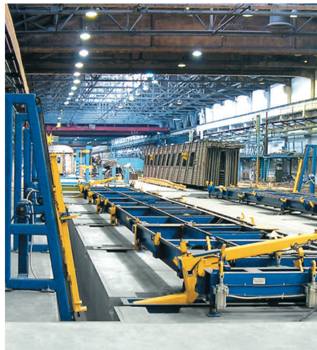
Кондуктор-кантователь для сборки и сварки боковых стен пассажирских вагонов
