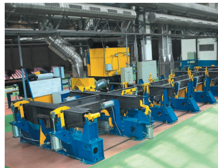
Стенд сборки и сварки рам полувагонов
