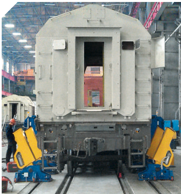
Передвижные домкратные установки для локомотивов
