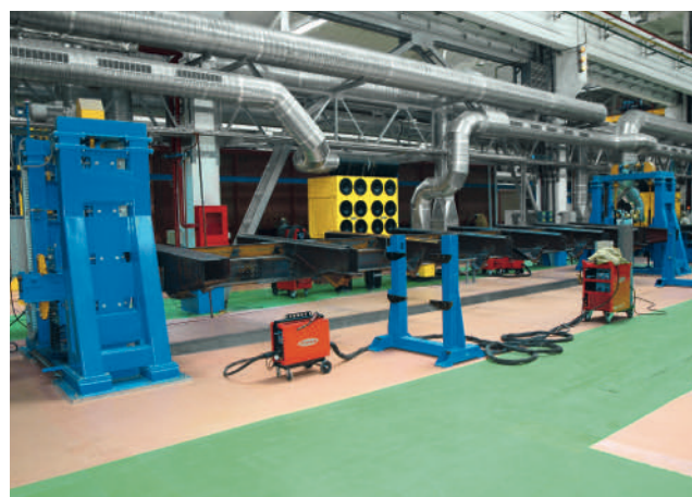
Кантователь с подъёмными центрами грузоподъёмностью 15 т
