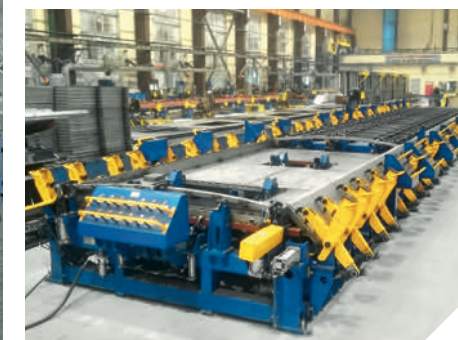
Универсальный стенд для сборки крыш вагонов метро
