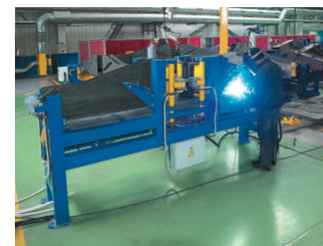
Стенд сборки промежуточных балок
