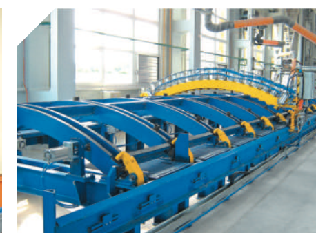
Стенд сборки и сварки обшивы крыши крытого вагона
