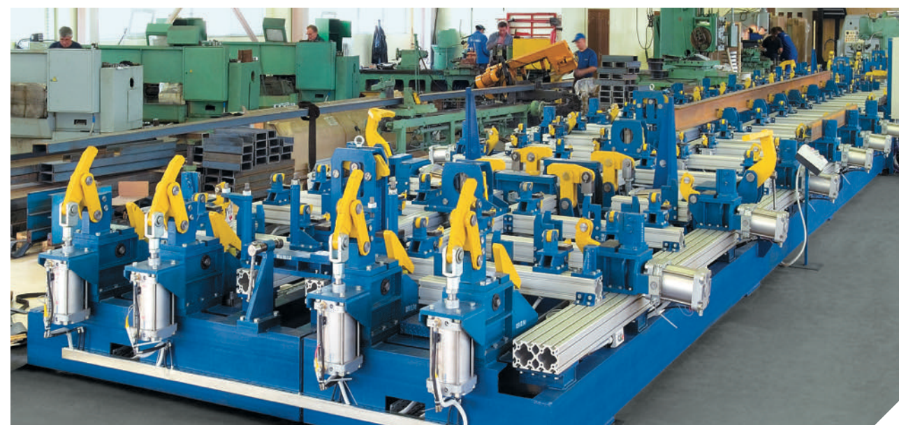
Универсальный кондуктор для сборки и сварки рам пассажирских вагонов
