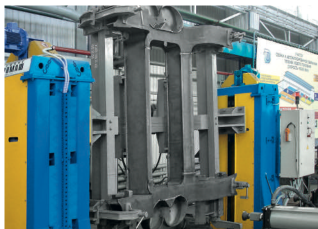
Кантователь с подъёмными центрами грузоподъёмностью 4,5 т
