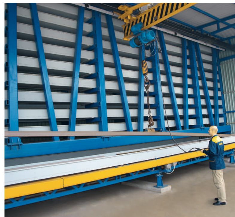
Автоматизированный склад профильного металлопроката
