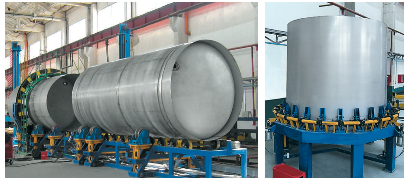
Линия сборки и сварки котла
