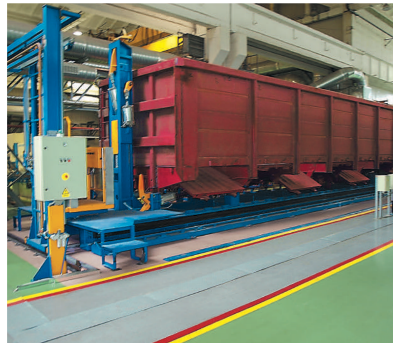
Стенд сборки и сварки кузова полувагона
