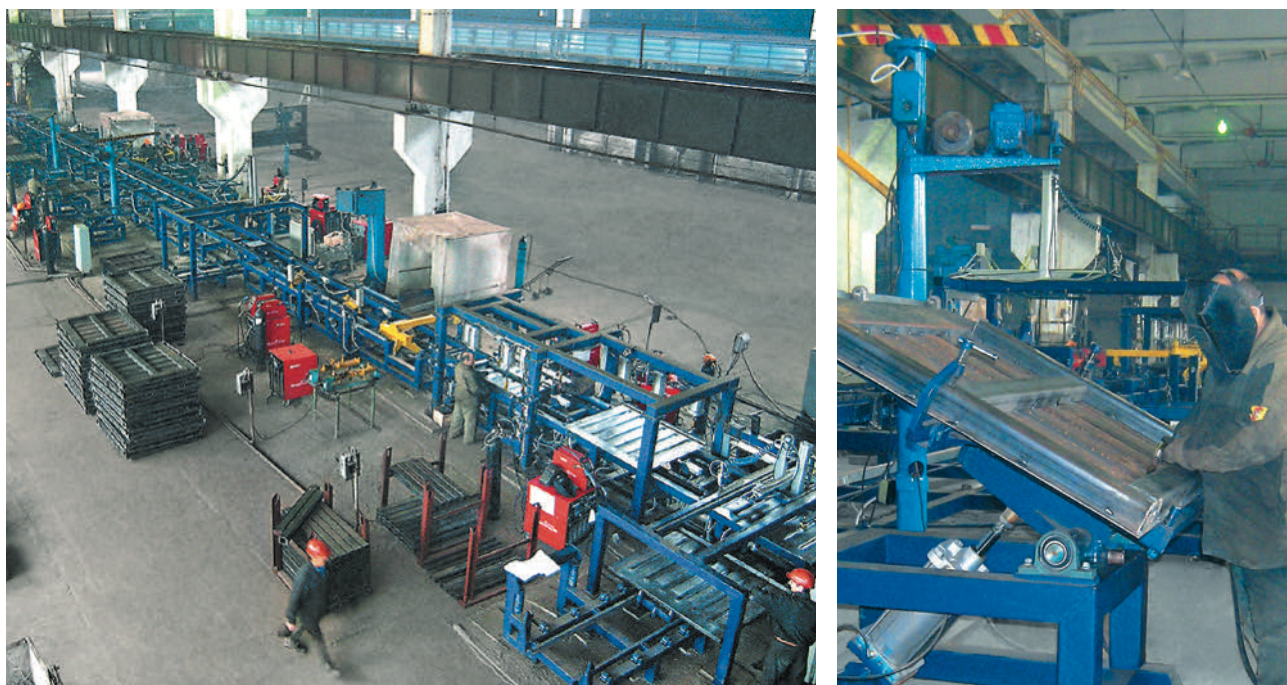
Комплексно-механизированная линия сборки и сварки крышек люков полувагонов
