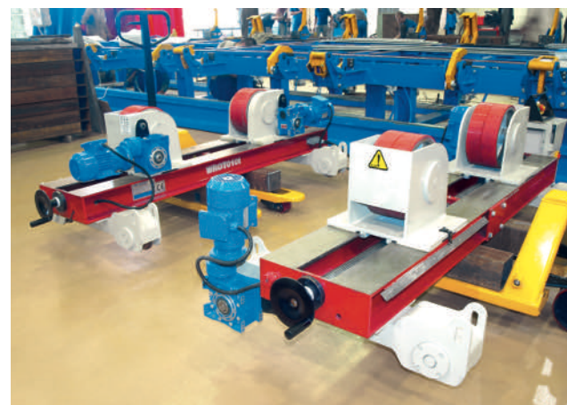
Роликоопоры различной грузоподъёмности
