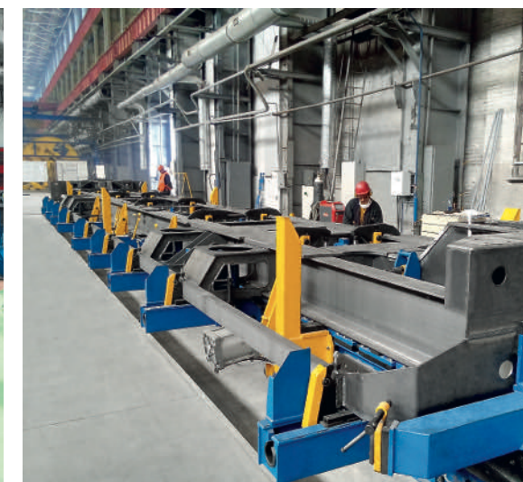
Универсальный стенд сборки рам тепловозов
