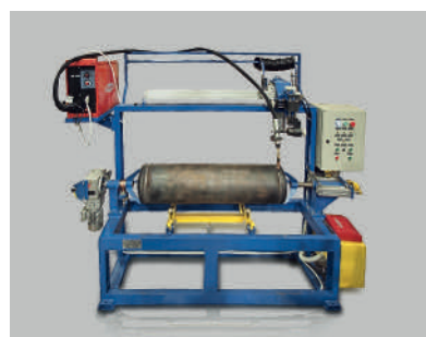
Стенд автоматической сварки доньшек с обечайкой
