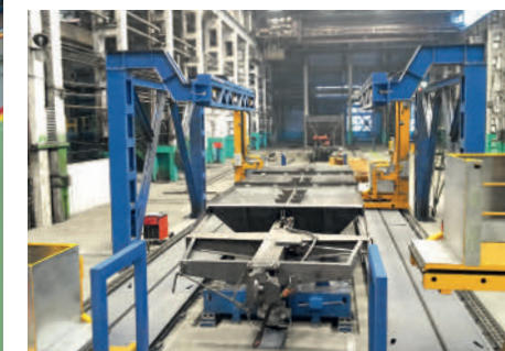
Стенд сборки кузова вагона-хоппера
