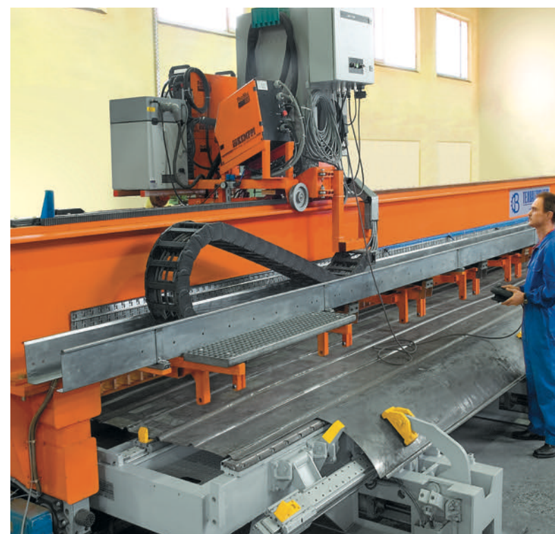
Стенд сборки и сварки обшивы крыши пассажирского вагона
