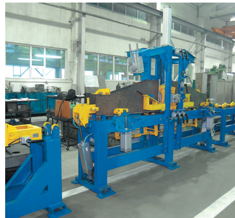
Линия сборки и сварки шкворневых балок
