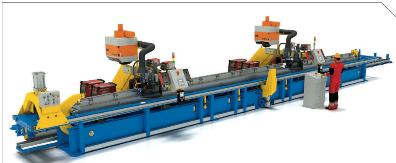
СТЕНД АВТОМАТИЧЕСКОЙ СВАРКИ ХРЕБТОВОЙ БАЛКИ С ДВУТАВРОМ
