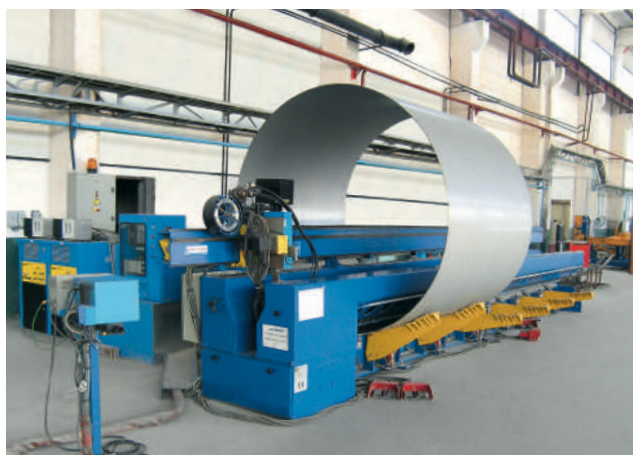
Стенд сварки обечаек
