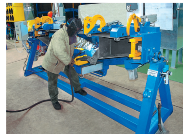
Сборка промежуточных балок грузовых вагонов
