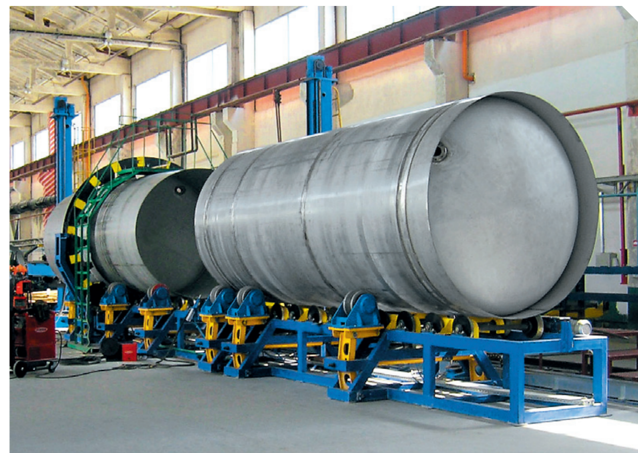
Линия сборки и автоматической сварки котлов
