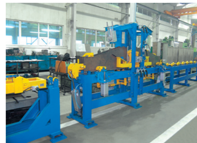
Сборка промежуточных балок грузовых вагонов
