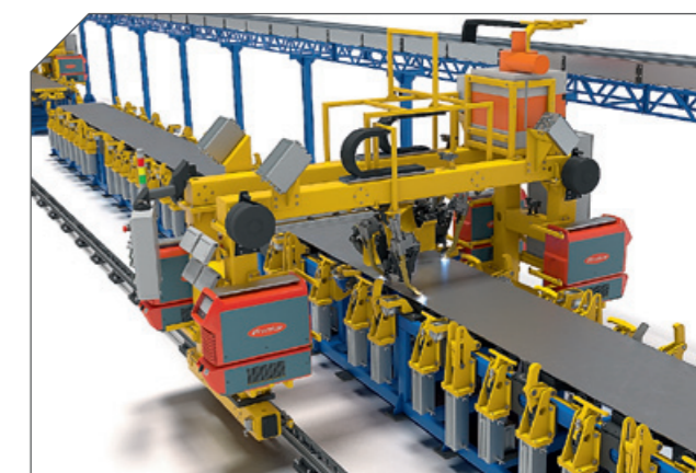
Портал автоматической сварки продольных швов
