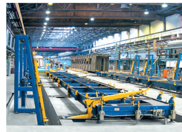
сборка боковых стен пассажирских вагонов
