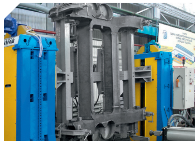
Кантователь с подъемными центрами грузоподъемностью 4 т
