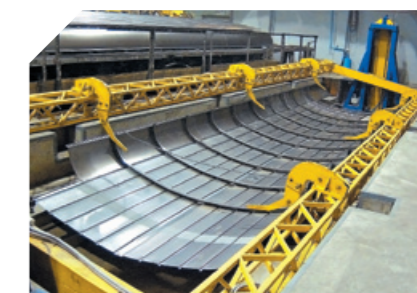
Кантователь сварки обшивки крыши вагонов
