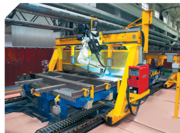
Роботизированная сварка стоек торцевой стены
