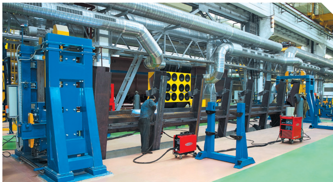
Кантователь с подъемными центрами грузоподъемностью 15 т
