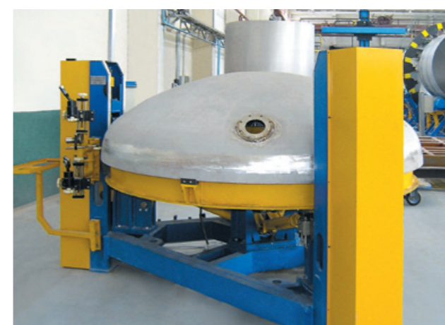
Стенд сборки, сварки днищ котла и торцовки юбки
