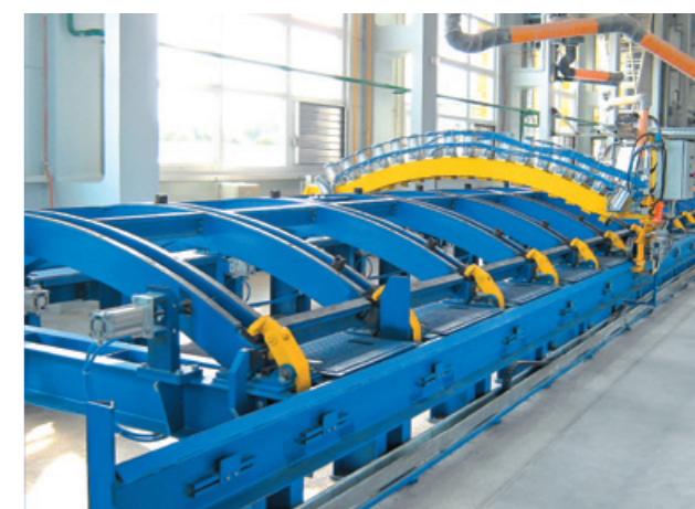
Стенд сборки крыш крытых вагонов
