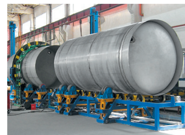
Линия сборки и сварки котла
