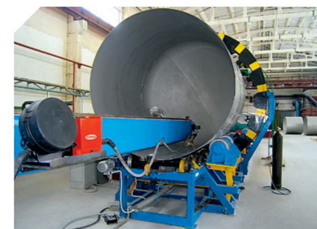
Сварка внутреннего шва
