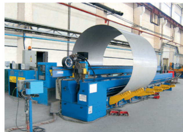
Стенд сварки обечаяек
