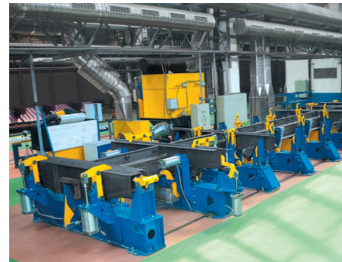
Стенд сборки и сварки рам полувагонов
