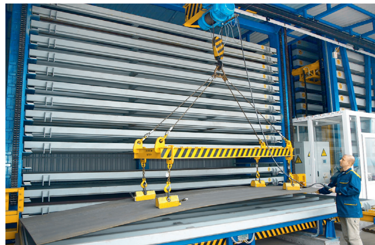
Автоматизированный склад листового металлопроката
