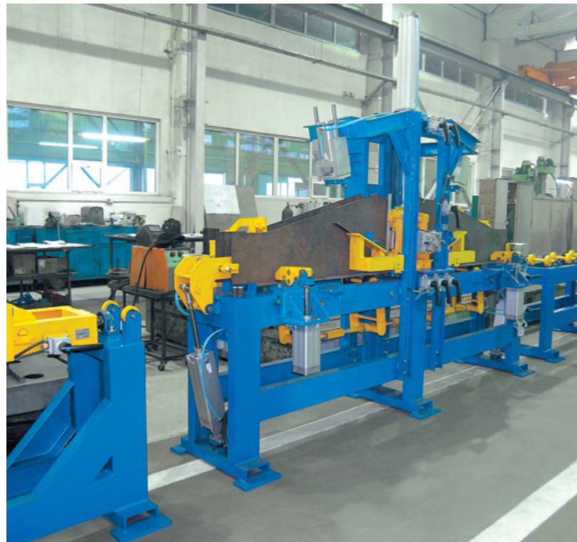
Линия сборки и сварки шкворневых балок
