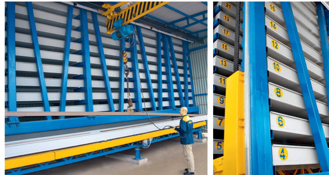
Автоматизированный склад профильного металлопроката
