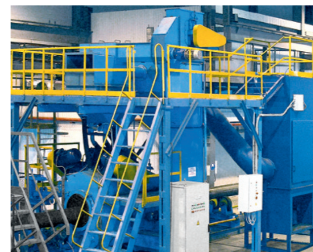
Дробеметные камеры для очистки труб
