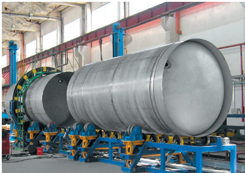
Линия сборки и сварки котла
