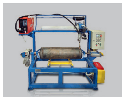
Стенд автоматической сварки доннышек с обечайкой
