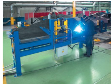
Стенд сборки промежуточных балок
