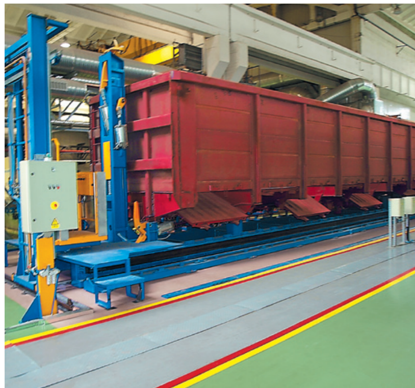
Стенд сборки и сварки кузова полувагона
