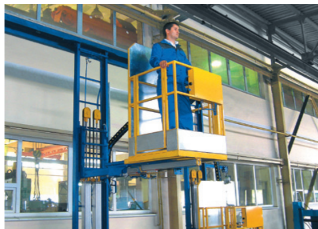
Подъёмные площадки для операторов
