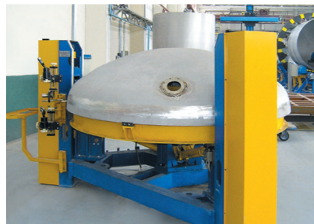
Стенд сборки, сварки днищ котла и торцовки юбки
