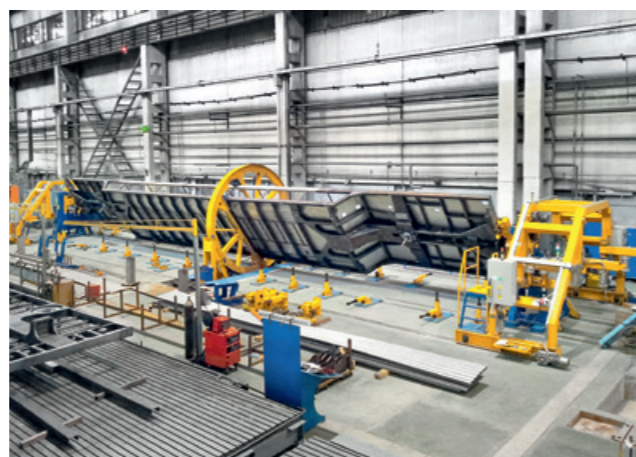
Стенд-кантователь с подъёмными центрами и поддерживающим кольцом (для длинных и нежёстких изделий)
