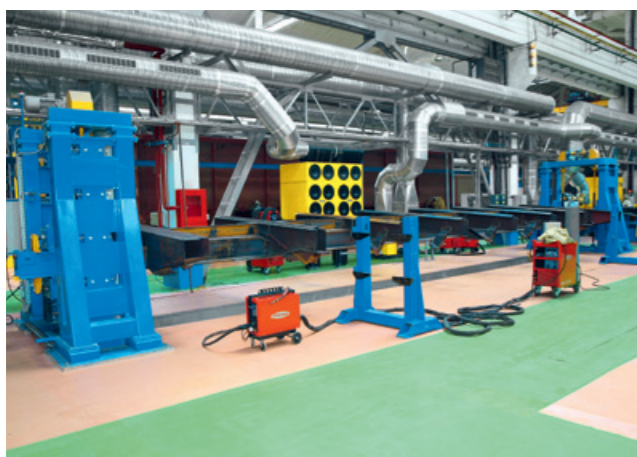
Кантователь с подъёмными центрами грузоподъёмностью 15 т
