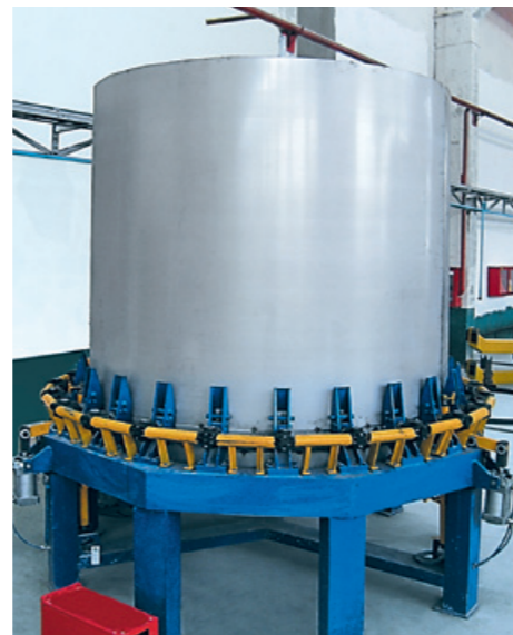
Стенд сборки обечайки с дном
