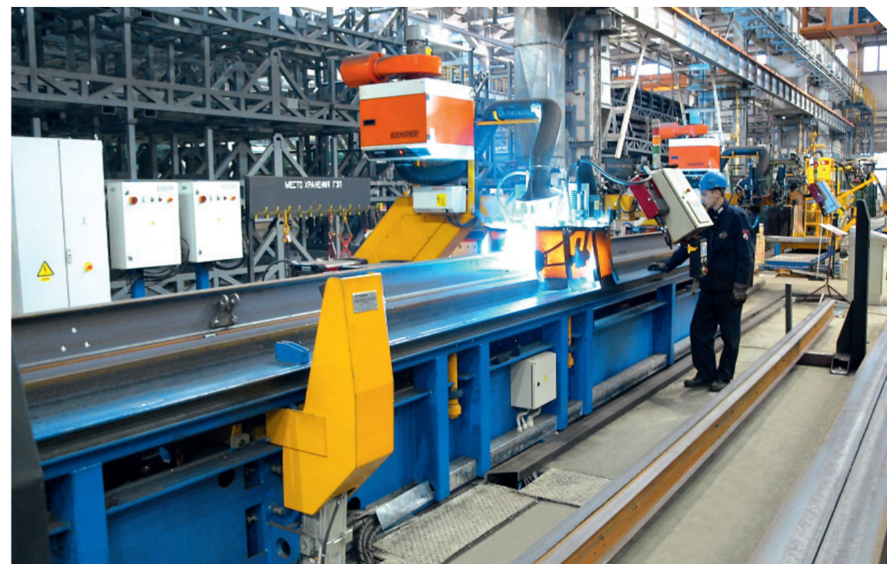
Стенд автоматической сварки хребтовой балки с двутавром
