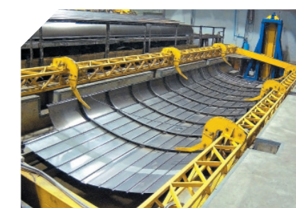
Кантователь сварки обшивки крыши вагонов
