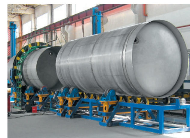
Линия сборки и сварки котла
