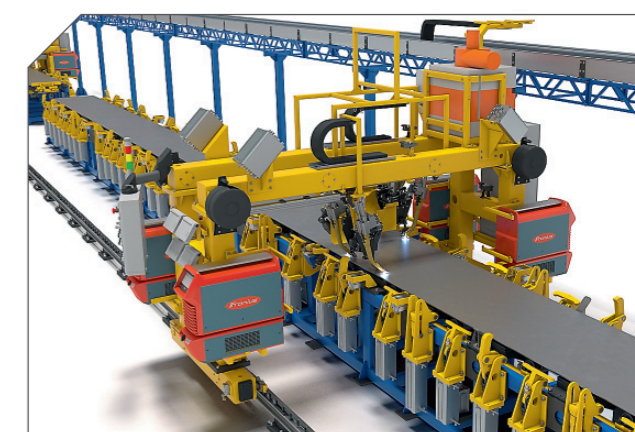
Портал автоматической сварки продольных швов
