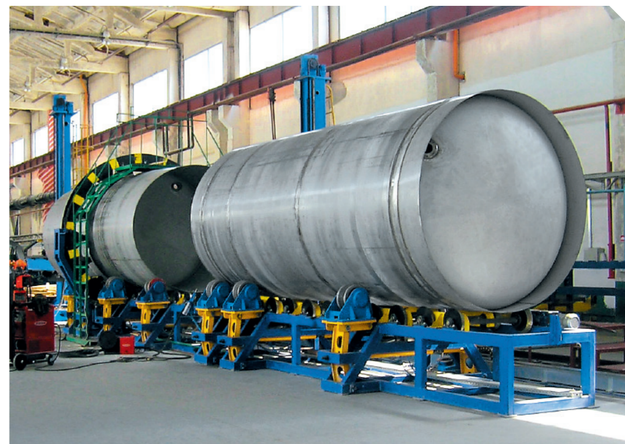
Линия сборки и автоматической сварки котлов
