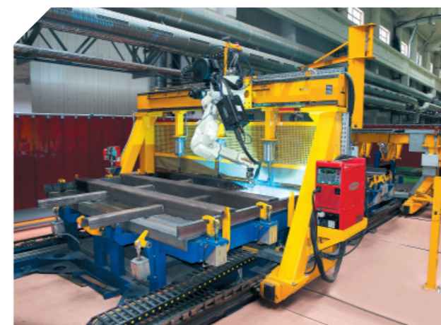
Роботизированная сварка стоек торцевой стены
