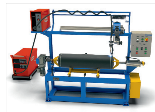
Стенд автоматической сварки обечайки с доньшком
