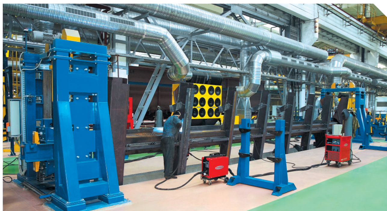
Кантователь с подъемными центрами грузоподъемностью 15 т
