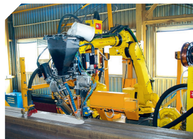
Лазерная система слежения за сварным швом META
