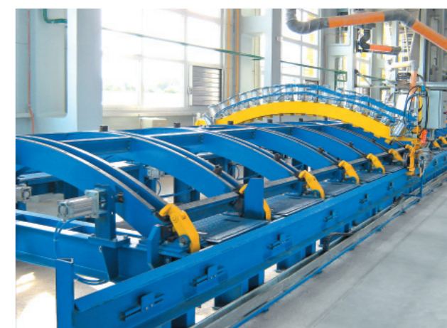
Стенд сборки крыш крытых вагонов
