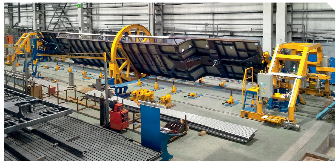
Стенд-кантователь с подъемными центрами и поддерживающим кольцом (для длинных и нежёстких изделий)
