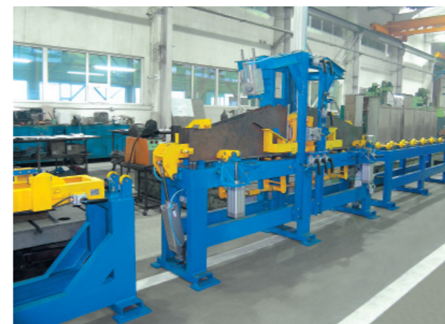
Сборка промежуточных балок грузовых вагонов
