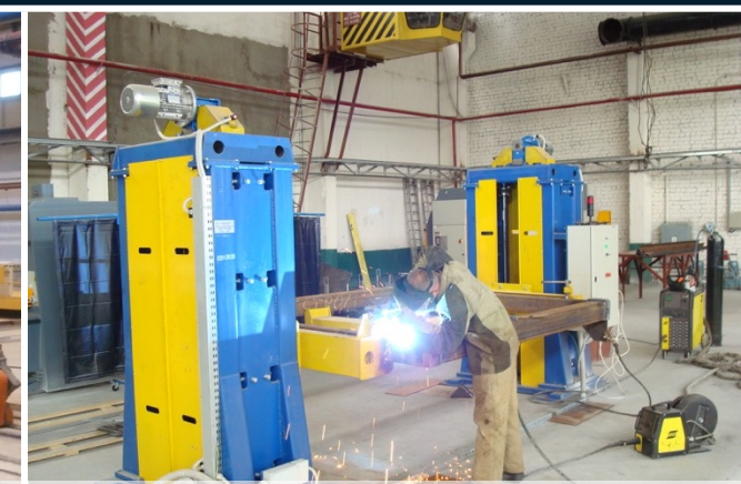
Кантувач в.п. 4 тонни
