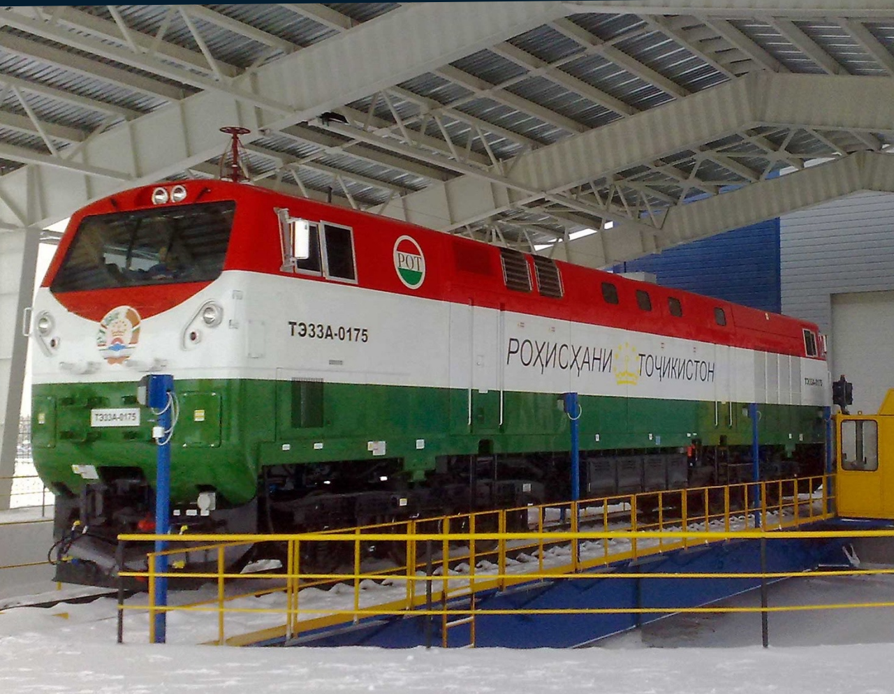
Поворотне коло г/п 150 тонн
