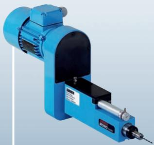
Handgeführte Bohreinheit für die Flugzeugzellen-Bearbeitung
