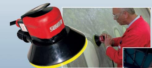
Lack- und Schmutz-entfernung an der Flugzeugzelle sowie an den Flügeln
