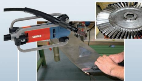
Präzisionsschleifen von Fan- und Kompressor-Blades
