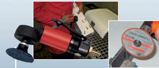
Bearbeitung der aus Composite-Material bestehenden Kabinen-Verkleidungen
